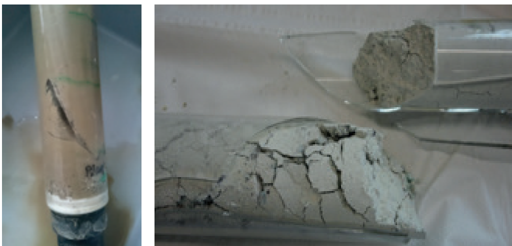
Abb. 1: links: stark verdichtete, nicht perkolierbare SFA in der Glassäule des Perkolationsverfahrens (DIN 19528); rechts: verfestigte, nicht perkolierbare Pfannenschlacke in zerbrochener Glassäule
